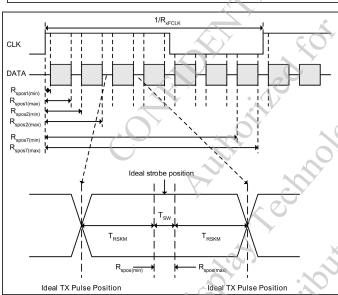
$T_{RSKM}$ : RECEIVER STROBE MARGIN  $R_{SPOS}$ : RECEIVER STROBE POSITION
